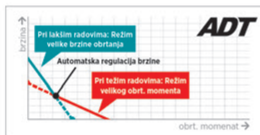
ADT tehnologija automatski reguliše brzinu rezanja u zavisnosti od opterećenja
