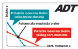
Automatsko prilagođavanje pogonskog momenta prema opterećenju
