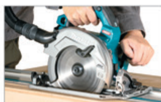
HS004G - Direktno priključiv lenjir bez ikakvog adaptera
